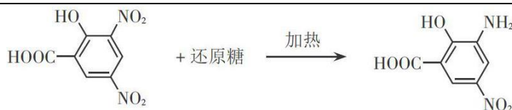
图1 3,5-二硝基水杨酸与还原糖的反应
