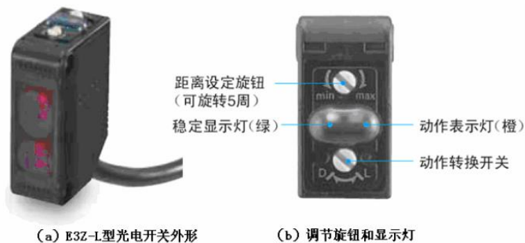
图 2-15 CX-441 (E3Z-L61) 光电开关的外形和调节旋钮、显示灯
