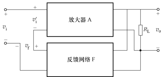
图4-7 电压串联负反馈模型框图
