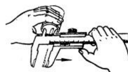
图2-9 内孔的测量方法
