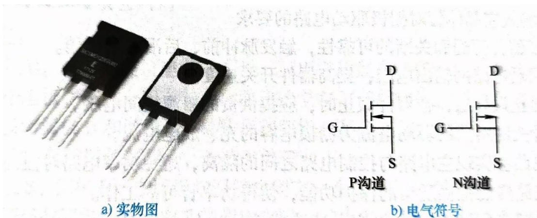
图 3-5 MOSFET 的实物图与电气符号
