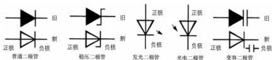
图 1 各种二极管的符号
