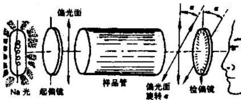
旋光仪的工作原理
