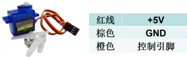
图 2 舵机 SG90-引脚接线图
