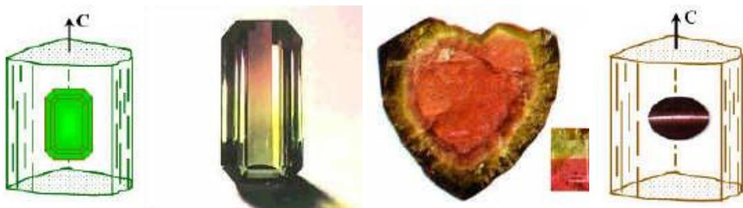
a. 绿色电气石定向 b. 多色电气石(台面//C轴) c. 西瓜电气石(台面⊥C轴) d. 电气石猫眼定向
