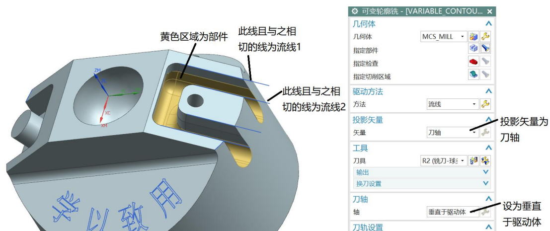
图 2-23 小平面编程参数设置
