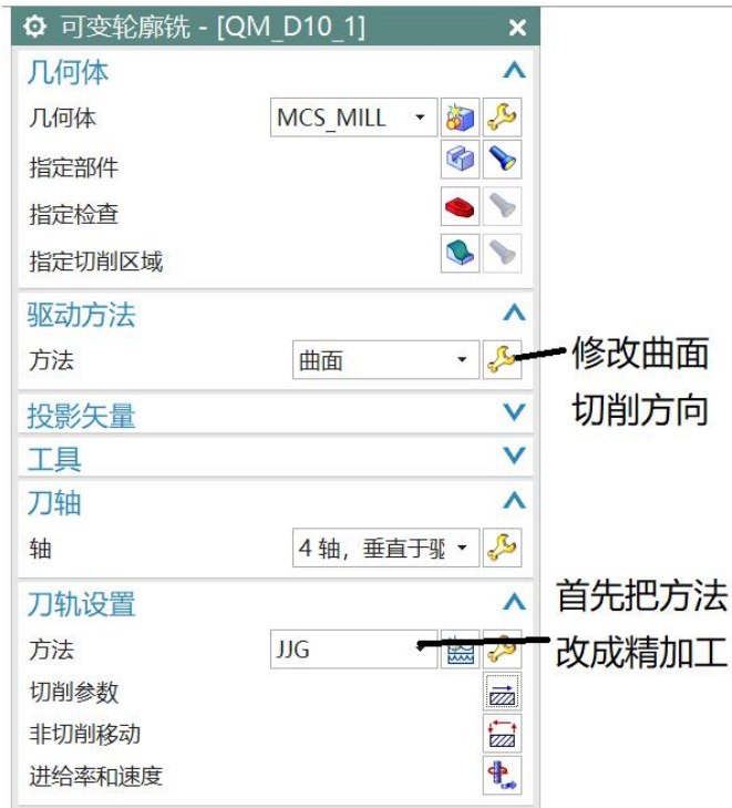
图 7-13 精加工参数修改
