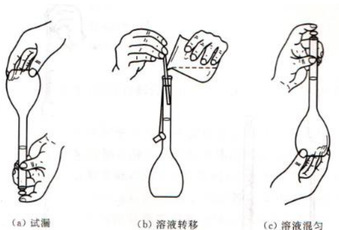
图 容量瓶的操作示意图
