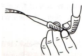
图 碱式滴定管排气方法
