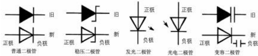
图 1 各种二极管的符号
