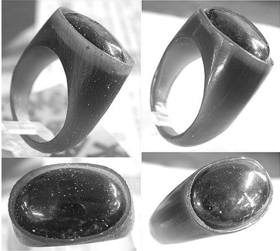
5 这4张照片是一组对照图，左边是已经大致整修完成的粗胚，宝石镶口的高度还没整修好，而右边的照片则是完成细抛完成的成品。
