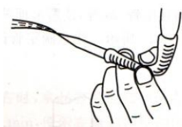
图 碱式滴定管排气方法
