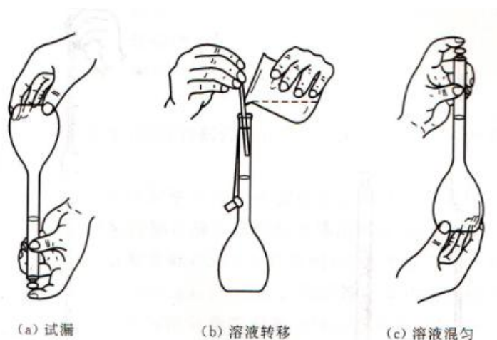
图 容量瓶的操作示意图
