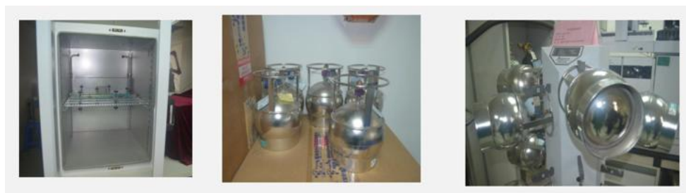
图 1-32 大气采样系统
