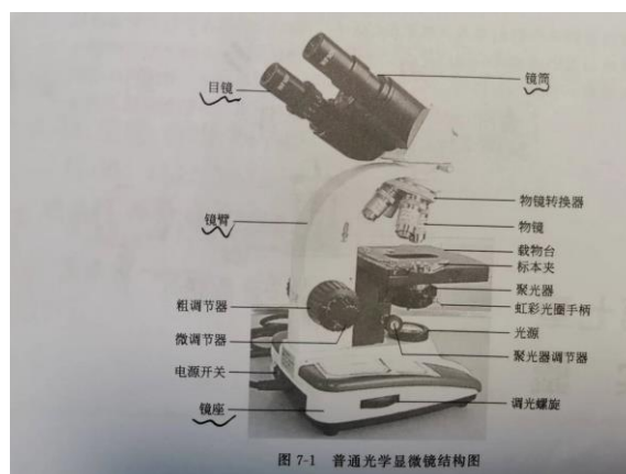
图 7-1 普通光学显微镜结构图
