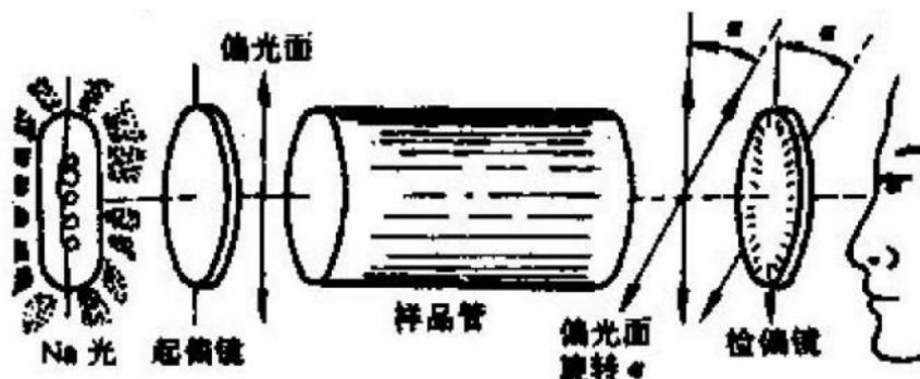
旋光仪的工作原理
