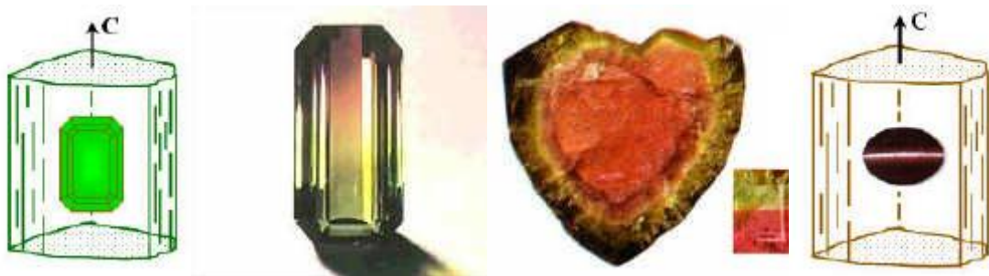
a. 绿色电气石定向 b. 多色电气石(台面//C轴) c. 西瓜电气石(台面⊥C轴) d. 电气石猫眼定向
