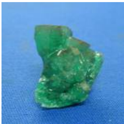
助熔剂合成祖母绿晶体
