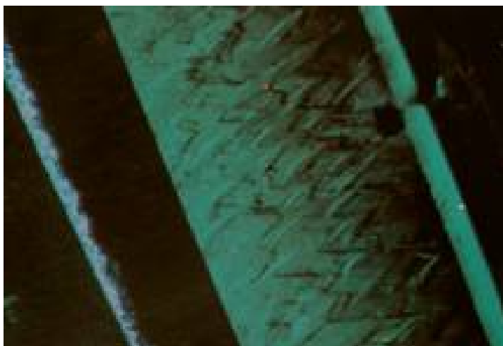
水热法合成祖母绿表面生长纹
