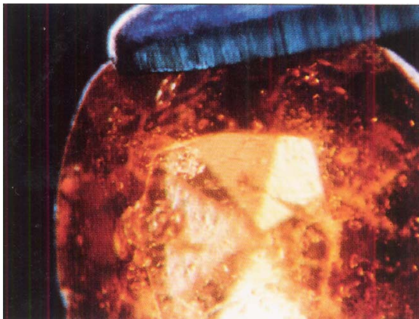
铁钙铝榴石中的旋涡包体
