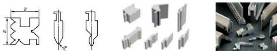
冲折弯机上通用弯曲模形状
