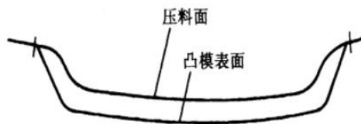
压料面展开长度比凸模表面展开长度短的示意图
