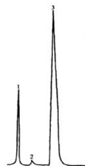
图 6-5 液体餐具洗涤剂甲醇含量测定的 GC 图例 1-甲醇; 2-乙醇; 3-异丙醇 (在 6min 处衰减由 1 变为 32)
