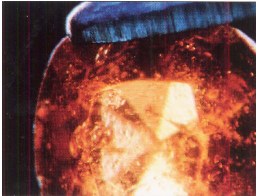
铁钙铝榴石中的旋涡包体
